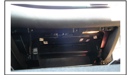
Handschuhfach öffnen und Bolzen an den Fangbändern entfernen
