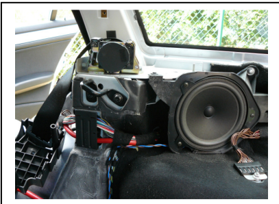
C-Säuleverkleidung rechts ausclipsen, Rücksitzbank ausbauen, rechte Sitzwange oben abziehen und entfernen, Abdeckung Gurt abziehen, Verkleidung unterm Fenster entfernen (2 Schrauben), Halter der LRA abschrauben (2 Torx), Spreizniet und 2 Schrauben in der Verzurröse entfernen, Verkleidung abnehmen
