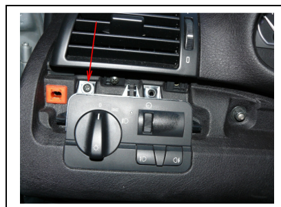
Abdeckung über Lichtschalter abziehen
