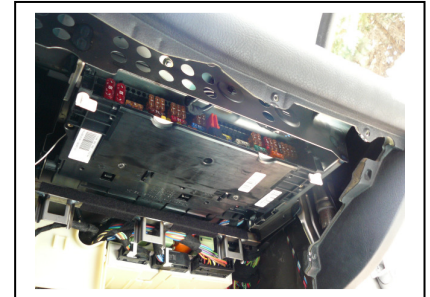
Rahmen des Handschuhfaches entfernen (6 Schrauben)
