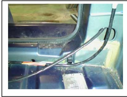
Kabel durch unteren Ausschnitt führen (Kabellänge knapp)
