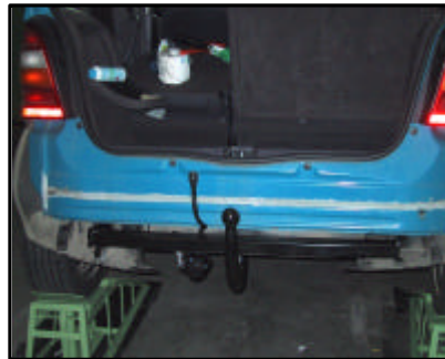
Kabeldurchführung des E-Satzes
