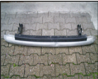
Ausbau des Pralldämpfers (Grundträger)
