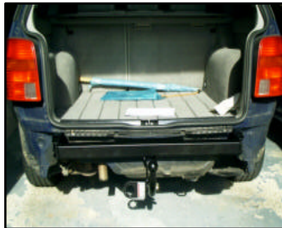
Anbau der AHK
