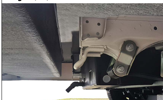
Image 4 (ex.): fin du châssis rallongé du camping-car
